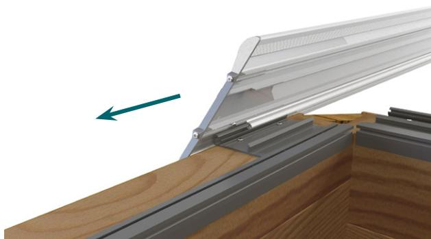
Avvitare le basi di fissaggio dei bordi (402) inserendo una vite a testa svasata (110) da 4,2 x 9,5 nel foro ovale di ciascuna base per evitare che i bordi si muovano. Per fare questo:
