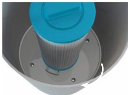
Fissare la guida di supporto del filtro (304) alla base del filtro (300) utilizzando due viti (105).
